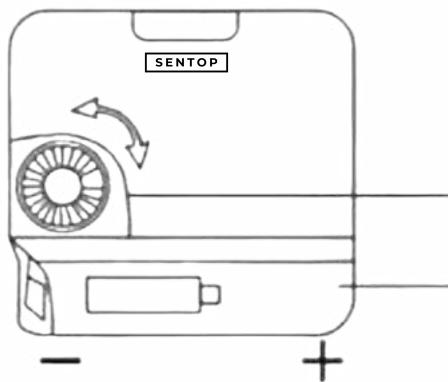
Ein Drehmechanismus auf der Rückseite des Uhrwerks, mit dem Sie die richtige Uhrzeit an der Wanduhr einstellen können.
