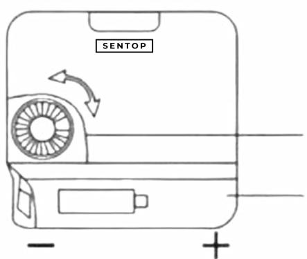
Un mécanisme rotatif au dos de l'horloge, avec lequel vous pouvez régler l'heure correcte sur l'horloge murale.
