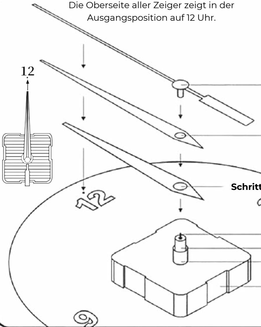
**Schritt 3:** Setzen Sie den Sekundenzeiger ein.
